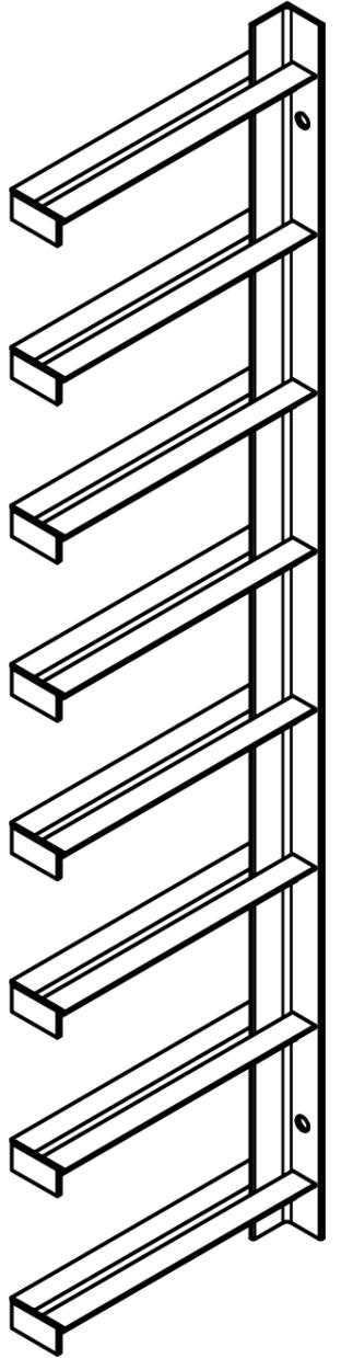
1. Толщина материала стойки и полки 3мм.
