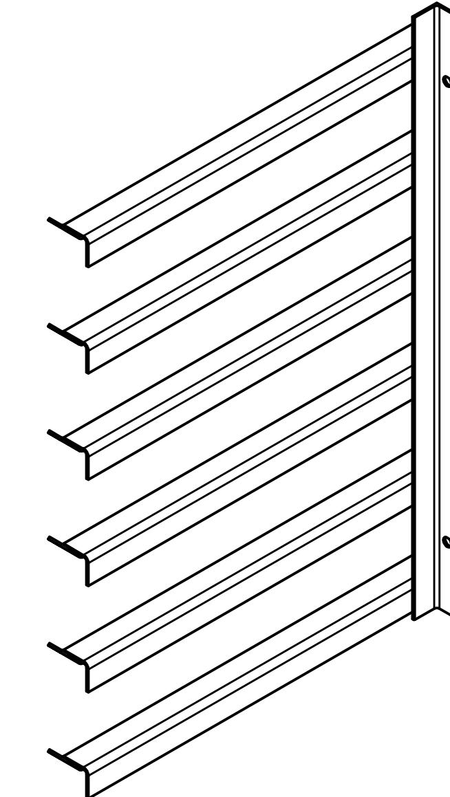
1. Толщина материала стойки и полки 3мм.
